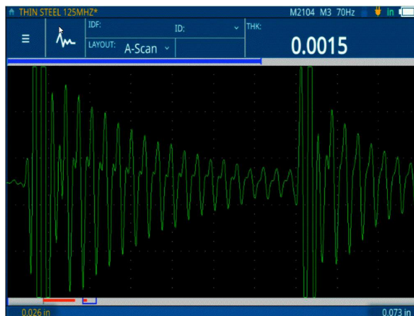
Le 72DL PLUS mesure une pièce d'acier de faible épaisseur (0,0381 mm)
